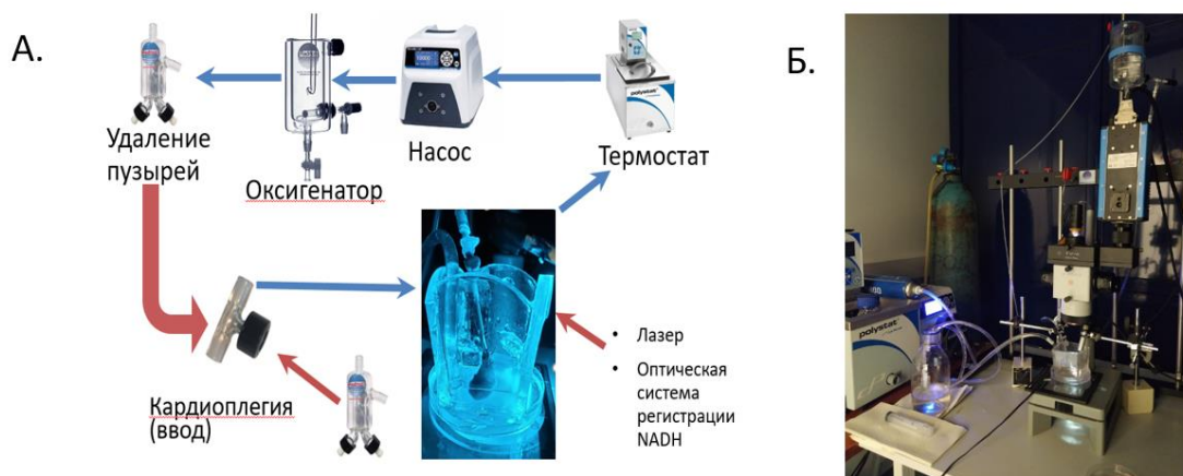
Рисунок 2. Общая схема сконструированной установки по постоянной перфузии сердца.
