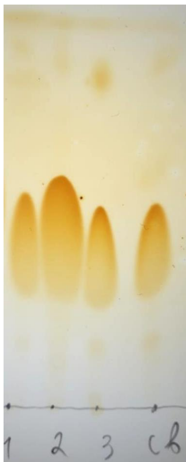
Рисунок 5. Хроматограмма маргарина (1), майонеза (2), халвы (3) и образца растительного масла в качестве свидетеля (св.)
