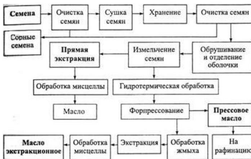
Схема 1. Технологическая схема получения растительного масла
