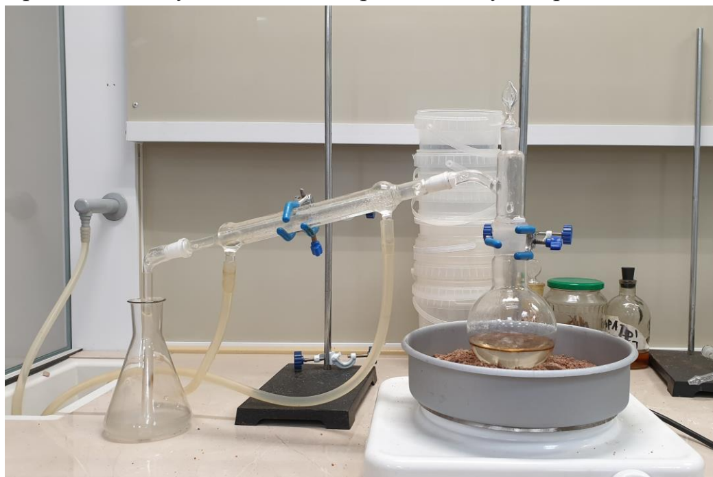
Приложение 2: установка для перегонки н-бутилбромида
