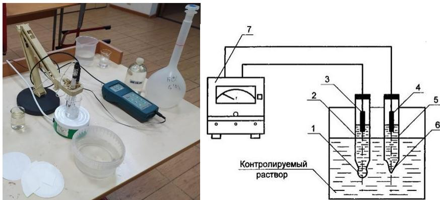
Рис. 5 рН-метр, схема устройства рН-метра
