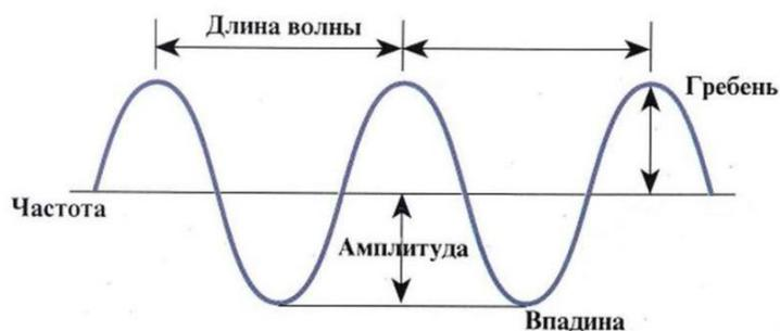
Рис. 1. Параметры электромагнитной волны.
