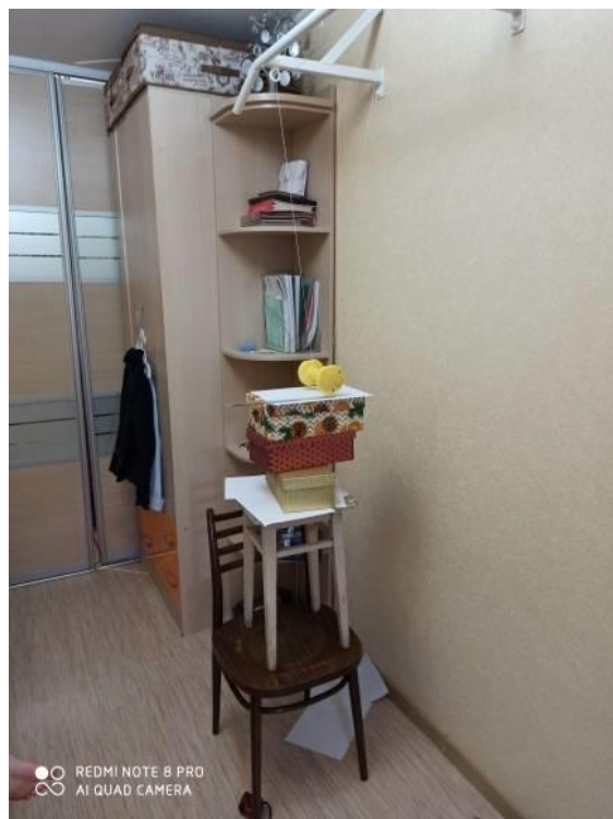
Рис. 3. Слева - малый груз на максимально длинном подвесе. Начальная амплитуда колебаний выставлялась по линейке с точностью порядка 0,5 см.
